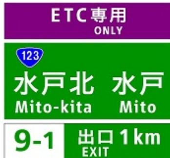
16 「方面及び出口の予告」、「方面、車線及び出口の予告」及び「方面及び出口」を表示する案内標識の標示板は、方面について、必要がある場合は、次に図示したものに準ずるものとするることができる。
