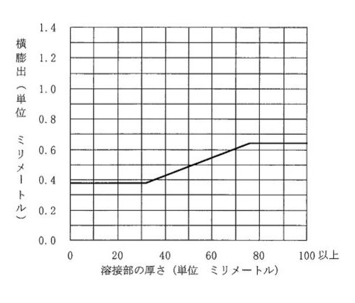
上であるときは、これを合格とする。 響部についてそれぞれ二個の試験片の破壊じん性の値が百三十二メガパスカル平方根メートル以 第二種特定設備の溶接部について破壊じん性試験を行つた場合において、溶接金属部及び熱影 高合金鋼 次のイ又は口に定める値 最低設計金属温度が零下百九十六度未満のものにあつては、○・五三ミリメートル最低設計金属温度が零下百九十六度以上のものにあつては、○・三八ミリメートル
