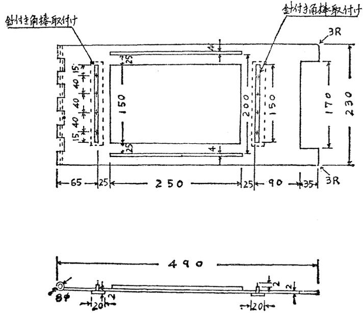
別図第2の3 試験体押さえ枠及びけい酸カルシウム板(第4条の3関係)
