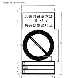
別記様式第1（第1条の2関係） 備考 1 色別は、文字、縁線及び区分線を青色、斜めの線及び枠を赤色、地を白色とする。 2 縁線及び区分線の太さは、1センチメートルとする。 3 図中の数字の単位は、センチメートルとする。 4 道路の標高又は交通の状況により特別な必要がある場合には、図示の寸法の倍まで拡大し、又は図示の寸法の半分で幅を縮小することができる。
