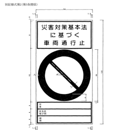
別記様式第2（第5条関係） 備考 1 色別は、文字、縁線及び区分線を青色、斜めの線及び枠を赤色、地を白色とする。 2 縁線及び区分線の太さは、1センチメートルとする。 3 図中の数字の単位は、センチメートルとする。 4 道路の標高又は交通の状況により特別な必要がある場合には、図示の寸法の倍まで拡大し、又は図示の寸法の半分で幅を縮小することができる。
