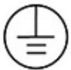
3 上記の記号は、接地極を表す。 4 接地極にあつては、11.7 ± 1の数値及び5以上とある規定は、適用しない。 図 8
