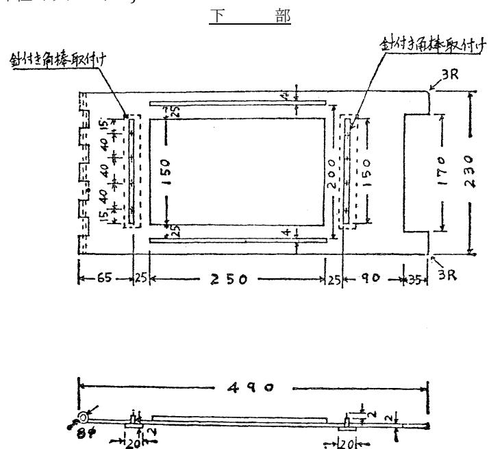
別図第2の3 試験体押さえ枠及びけい酸カルシウム板(第4条の3関係)
