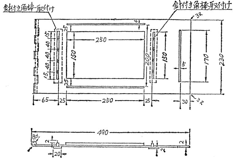
別図第2の2 試験体支持枠(第4条の3関係)
