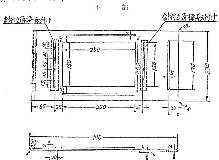
別図第2の2 試験体支持枠(第4条の3関係)
